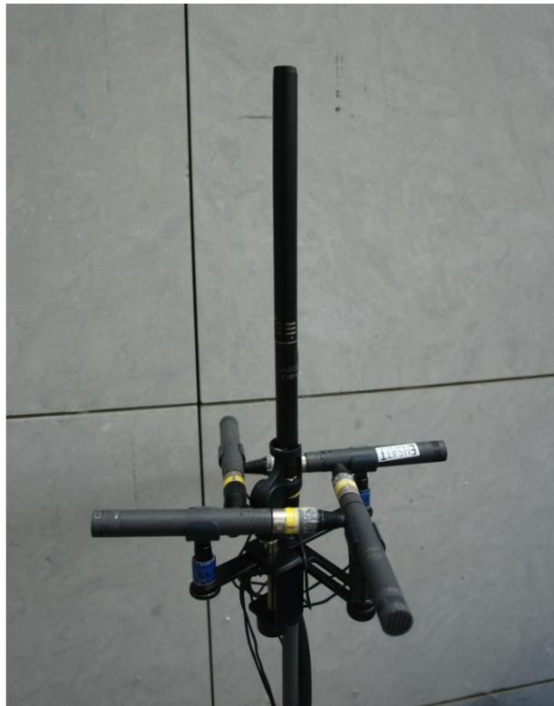
Fig. 9 : Le système de mesure de réponse impulsionnelle à 5 micros, 2016, photo personnelle.
